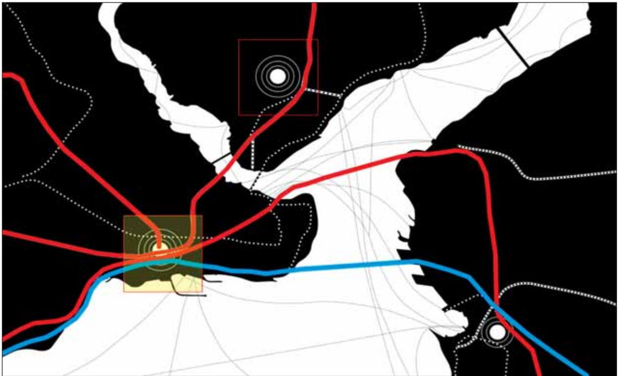
Redes infraestructurales previstas: en rojo, las líneas de metro; en azul, la ferrovía subterránea y submarina; con la línea de puntos, las rutas marítimas; en amarillo el transfer point en el que estas redes se entrecruzan.
