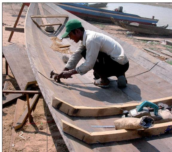
**Figura 1.** Este carpintero de ribera de Siem Reap (Camboya) en el año 2005, con ayuda de un martillo, torcía una barra de hierro para obtener el perfil interno de una parte de la embarcación ya construida. Posteriormente, utilizando la barra de hierro como plantilla, tallaría la cuaderna con la forma exacta. Se trata de una embarcación que responde al principio de construcción naval conocido como casco previo.
