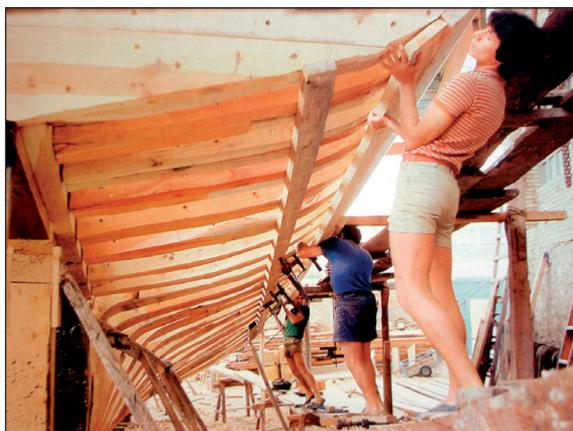
**Figura 4.** La construcción naval sobre esqueleto tiene como característica más evidente el que las tablas del forro se clavan sobre el conjunto formado por el eje axial del barco y las cuadernas, cuando estos elementos estructurales esenciales están ya contruidos.
