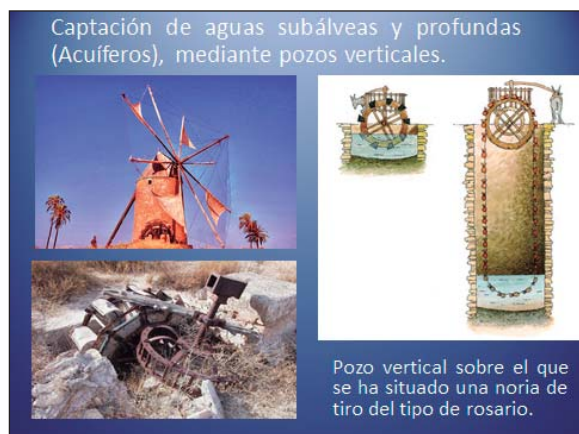
Figura 14. Extracción de aguas subálveas con pozo vertical.
