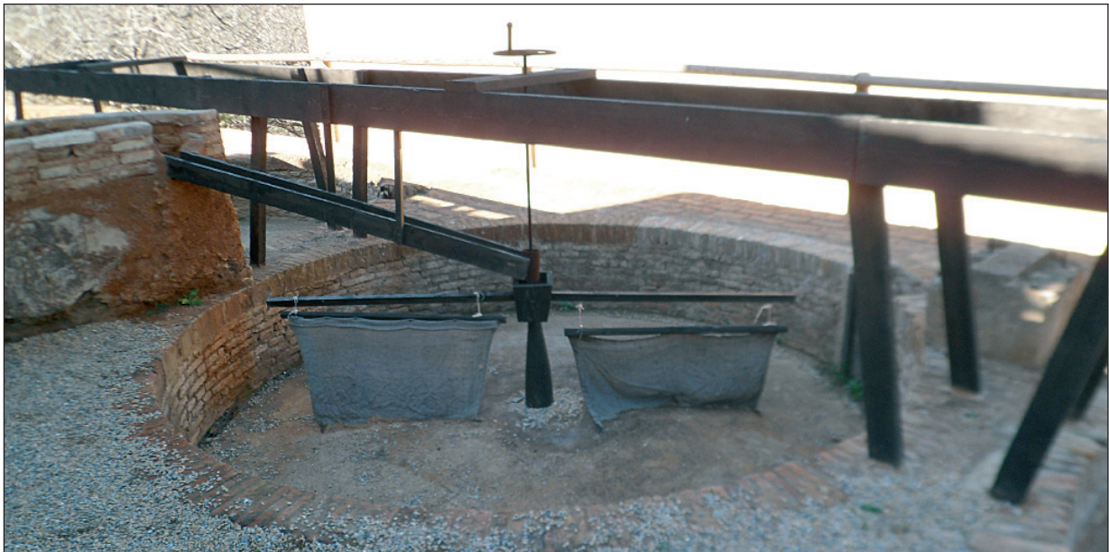
Figura 7. Rumbo restaurado del lavadero gravimétrico de la Mina Remunerada del Parque Minero de La Unión. Autor: OGV.
