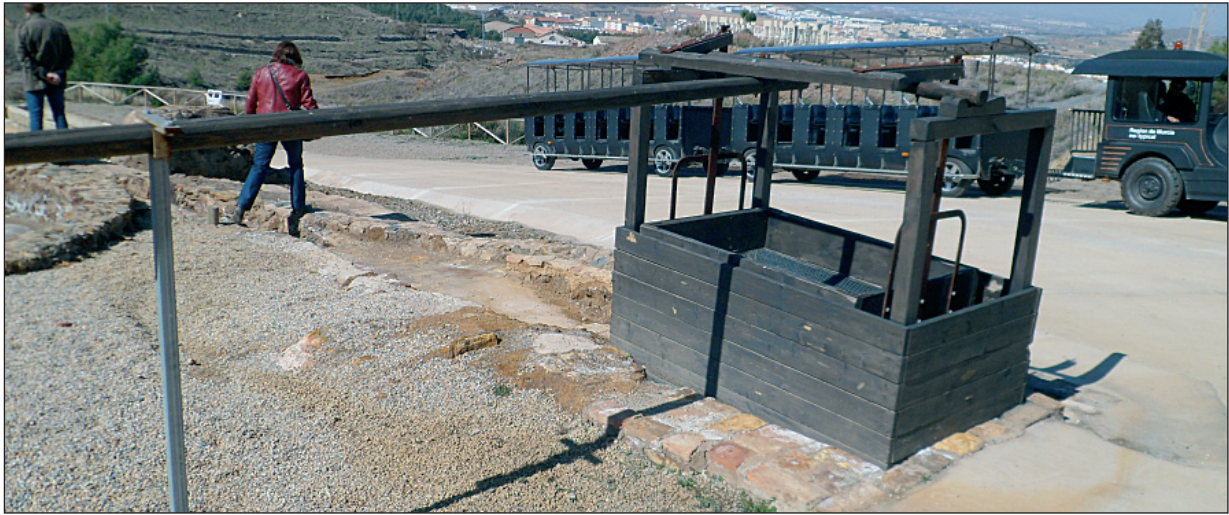
Figura 6. Criba cartagenera junto al lavadero gravimétrico de la Mina Remunerada en el Parque Minero de la Unión. Autor: OGV.
