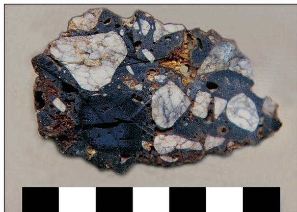
**Figura 4.** Fragmento de escoria plomo-plata de sílice libre. Escala en cm. (Foto M. Hunt).
