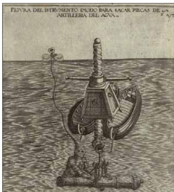
Figura 6. Modo ideado por Ufano para recuperar piezas de artillería hundidas.
