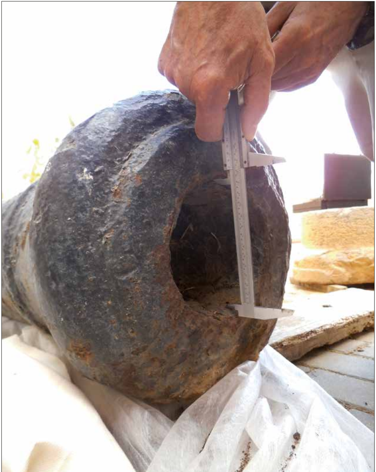
Figura 18. Obteniendo el calibre de una pieza de artillería. (Fotografía del autor).
