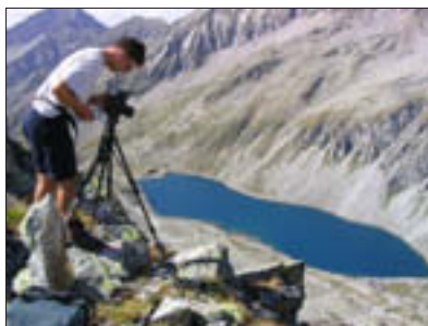
Figura 2. Toma de datos con una cámara fotogramétrica.
