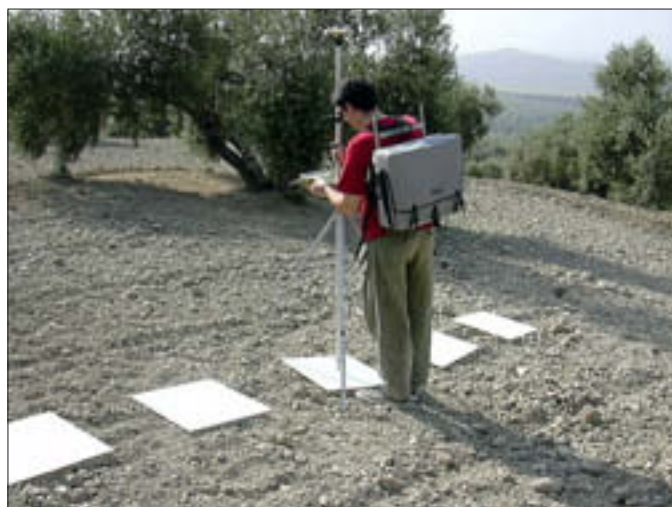
Figura 4. Toma de datos para determinación del modelo digital del terreno.
