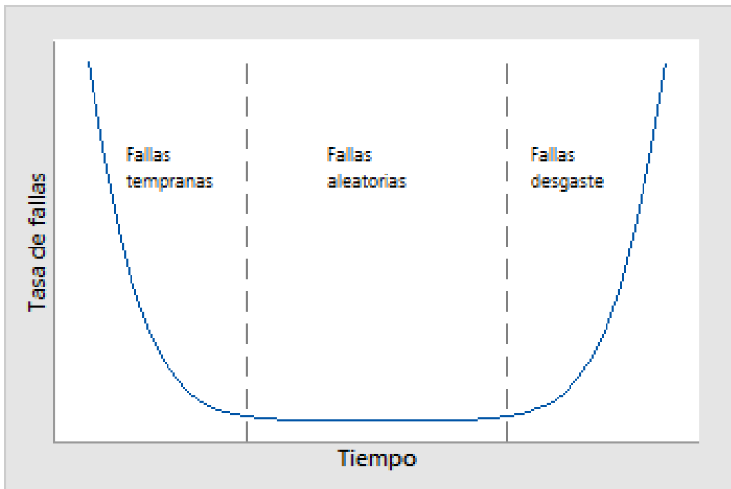
Figura 1.2: Ejemplo de razón de fallo de tipo bañera. Extraída de [11].
