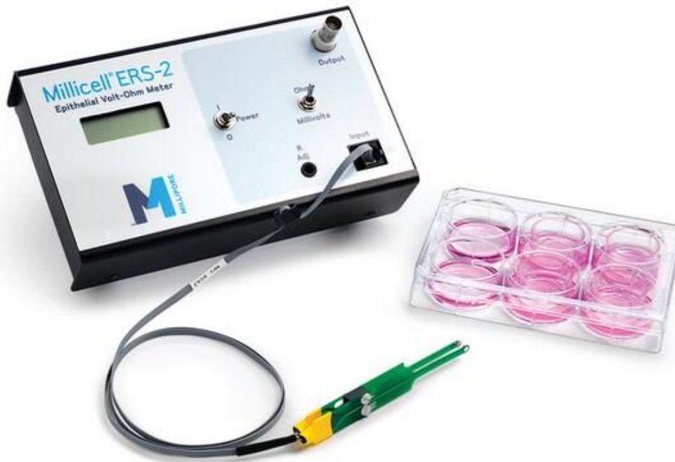
**El Sistema Millicel - ERS (Electrical Resistance System) mide potencial de membrana & resistencia de células epiteliales en cultivo**
