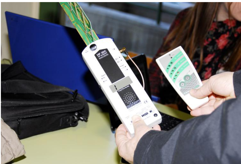
Medición realizada mientras un grupo de estudiantes utilizan wifi en el Hall de la Facultad. El medidor de alta frecuencia HF35C utilizado sólo puede registrar valores de hasta 2000 \mu\text{W}/\text{m}^2 , cuando éstos son superiores muestra un 1 a la izquierda, tal como puede observarse en la imagen. Por otro lado, el detector ESI 23 se ilumina con el color rojo en hf wave, advirtiendo anomalía extrema ( > 2000 \mu\text{W}/\text{m}^2 ).
