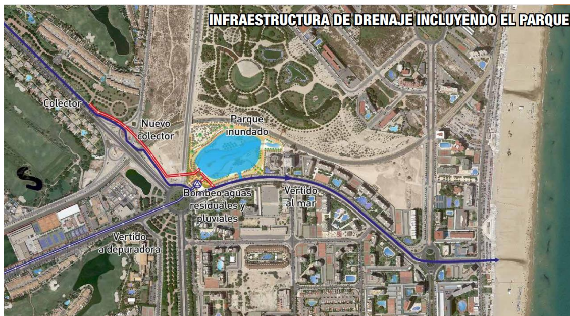
Ilustración 32 Infraestructura de drenaje incluyendo el parque La Marjal
