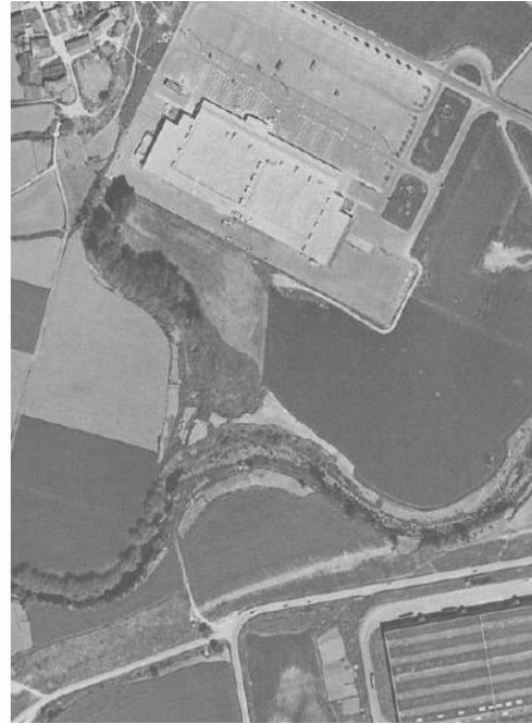
Ilustración 34 Corta y relleno de un meandro del río Zadorra para realizar un centro comercial
