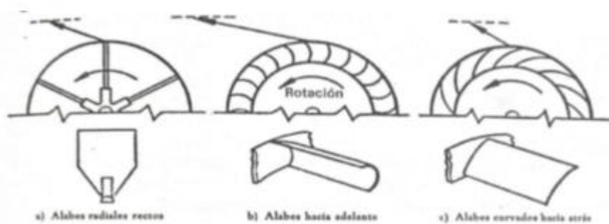
Fig. 15-3. Diferentes modelos de álabes para ventilador centrífugo.
