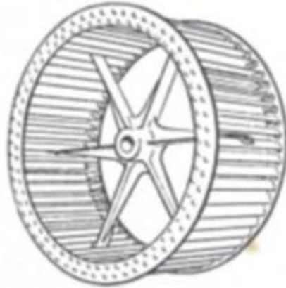
Fig. 15-6. Rueda con álabes curvados hacia adelante.
