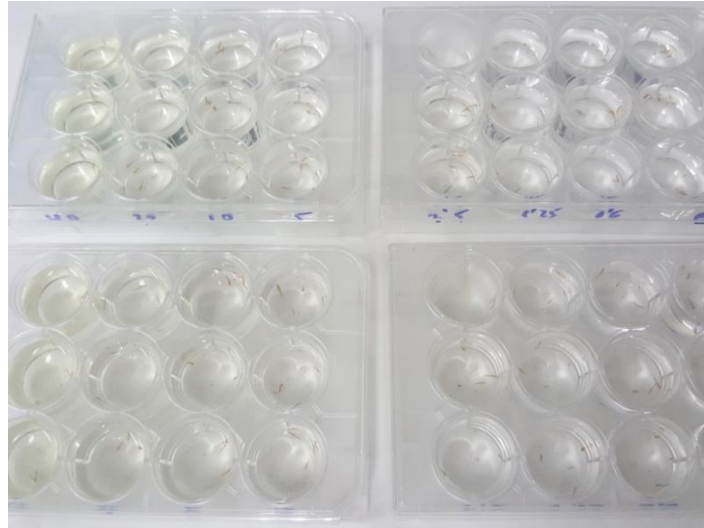
Figura 2. Microplaca donde se realizó ensayo de toxicidad con K_2Cr_2O_7 (Fuente: elaboración propia)
