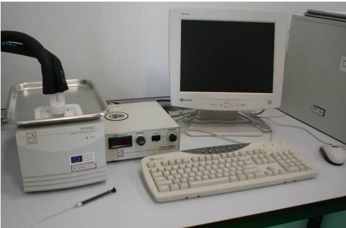
**7.- Sistema en flujo continuo para la detección y el análisis cinético de interacciones moleculares por *Surface Plasmon Resonance***
