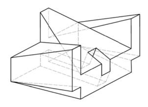
*Ejercicio 2:* Se da la perspectiva de una pieza mecánica. Realizar el número mínimo de vistas necesarias para definirla seleccionando el alzado más conveniente. No se establece escala de trabajo y se podrá operar a mano alzada o, si se desea, con instrumentos. Cuídese la proporción y correspondencia.
