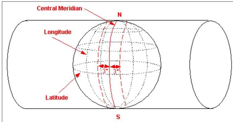
Figura 1.10: Cilindro generador de la proyección UTM
