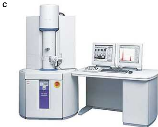
Lámina 4. A.- Microscopio Electrónico de Barrido Ambiental (ESEM); B.- Microscopio electrónico de Barrido que puede trabajar sin metalización previa de las muestras; C.- Microscopio Electrónico de Barrido para Transmisión (STEM); D.- Microscopio Electrónico de Barrido preparado para analizar muestras congeladas (Crio-SEM); E.- Detalle de la crio-cámara adosada a la cámara de visualización propia del SEM.
