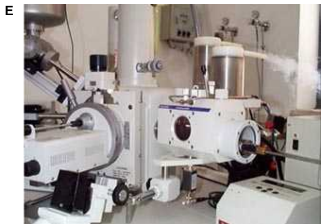
Lámina 4. A.- Microscopio Electrónico de Barrido Ambiental (ESEM); B.- Microscopio electrónico de Barrido que puede trabajar sin metalización previa de las muestras; C.- Microscopio Electrónico de Barrido para Transmisión (STEM); D.- Microscopio Electrónico de Barrido preparado para analizar muestras congeladas (Crio-SEM); E.- Detalle de la crio-cámara adosada a la cámara de visualización propia del SEM.
