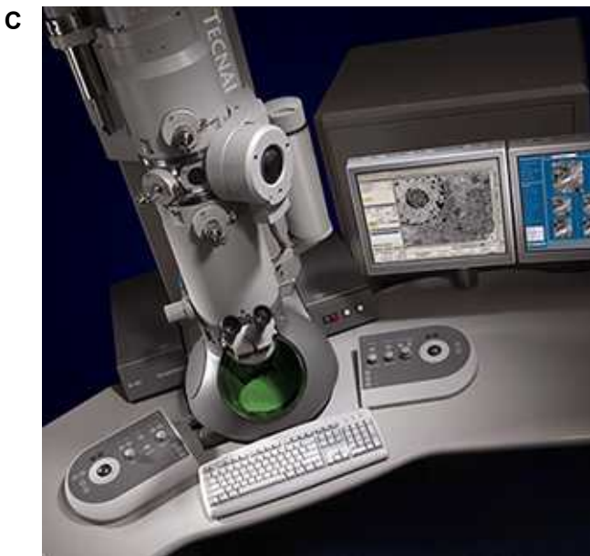
Lámina 1. Microscopio electrónico de transmisión. A.- Esquema comparado de un microscopio óptico, un electrónico de transmisión (TEM) y uno de barrido (SEM), como se puede observar la estructura del SEM es un poco diferente. B.- Partes de un TEM del año 1969: (1) cable de alta tensión, (2) emisor de electrones, (3) motor para centrar el haz del emisor de electrones, (4) condensador, (5) control de apertura del diafragma, (6) portamuestras, (7) objetivo (lente condensador), (8) proyector (lente condensador), (9) binocular óptico de observación, (10) pantalla fluorescente, (11) bomba de vacío, (12) goniómetro, (13) control de vacío y de aumentos, (14) control de enfoque. C.- Aspecto de un TEM actual con sistema de captura de imágenes
