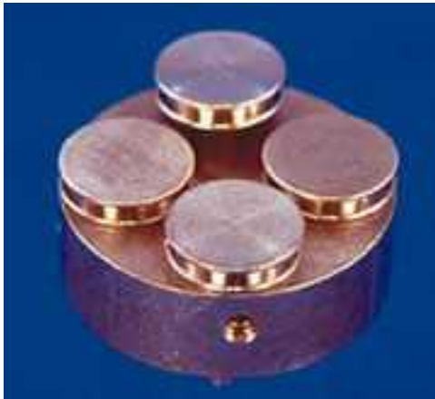
Lámina 2. A.- Pedestales para el montaje de muestras al SEM; B.- Cinta conductora de doble capa y pegamentos conductores especiales para fijar las muestras al SEM
