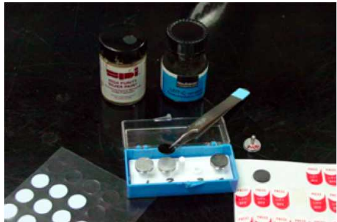
Lámina 2. A.- Pedestales para el montaje de muestras al SEM; B.- Cinta conductora de doble capa y pegamentos conductores especiales para fijar las muestras al SEM
