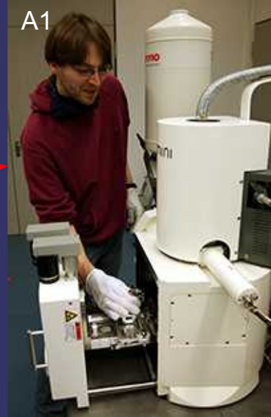
Diferentes aspectos de cámaras de vacío del SEM donde se introduce la muestra metalizada
