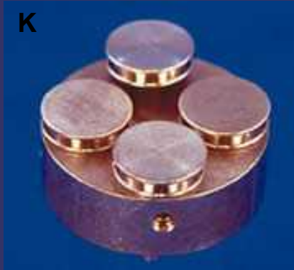
Diferentes tipos de pedestales y útiles para fijar la muestra (cinta de doble capa y pegamento de Ag)
