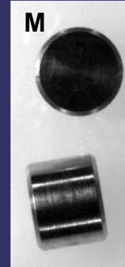
Diferentes tipos de pedestales y útiles para fijar la muestra (cinta de doble capa y pegamento de Ag)
