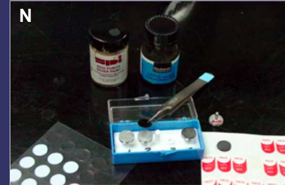
Diferentes tipos de pedestales y útiles para fijar la muestra (cinta de doble capa y pegamento de Ag)
