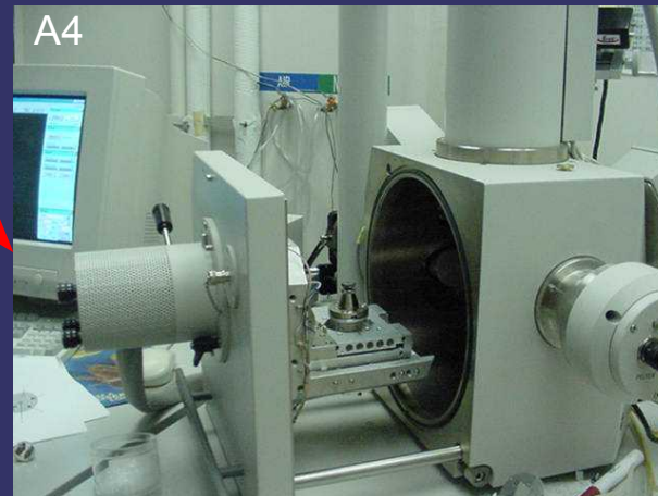
Diferentes aspectos de cámaras de vacío del SEM donde se introduce la muestra metalizada
