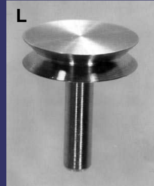
Diferentes tipos de pedestales y útiles para fijar la muestra (cinta de doble capa y pegamento de Ag)
