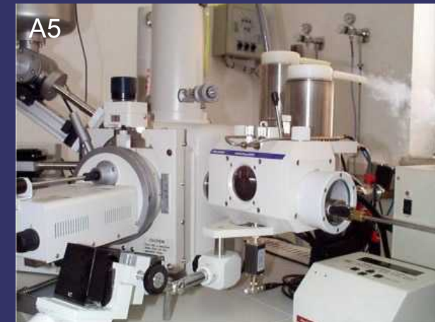
Cámara criogénica para la visualización de muestras congeladas, que pueden tener acoplada algunos SEM
